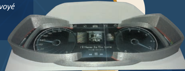
3 - Essai du prototype non peint sur gabarit
